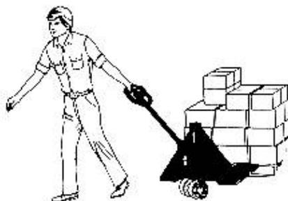
**Fig. 8: Tracción en posición de trabajo<**
